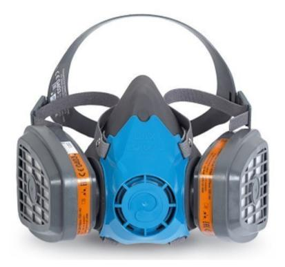
Комфортный, гипоаллергенный и легкий корпус полумаски из ТПЭ. Полностью разборная конструкция, сменные фильтры, надежная фиксация и быстрое расстегивание шейных пряжек. Удобная регулировка тесьмы и подгонка размера, регулируемый наголовник, сочетается со средствами защиты головы и глаз, байонетное крепление фильтров. ТР ТС 019/2011, ГОСТ 12.4 235-2012, ГОСТ Р 12.4.190-99, ГОСТ 12.4.246-2013
